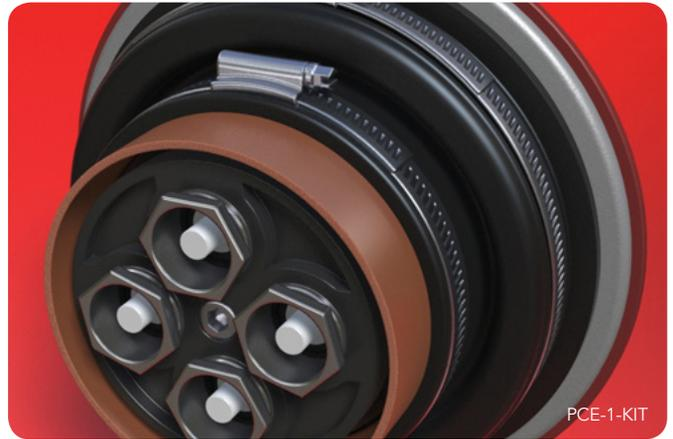
Les presse étoupe Fibrelite s'installent simplement par le perçage d'un trou, pas de trous supplémentaires pour des vis. Cela amène une facilité et rapidité d'installation tout en minimisant les potentielles entrées d'eau. Les joints des presse étoupe sont résistants aux hydrocarbures (nitrile ou Viton) et leur forme en soufflet compensent les éventuels mouvements de terrains.
