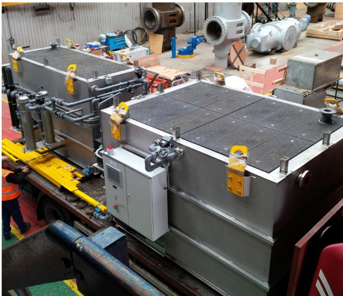
*Dois sistemas que foram adaptados para as tampas de caleiras Fibrelite de forma a permitirem acesso pela parte superior*
