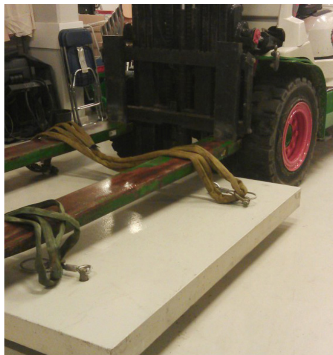
Dawna czasochłonna metoda usuwania ciężkiej płyty betonowej
