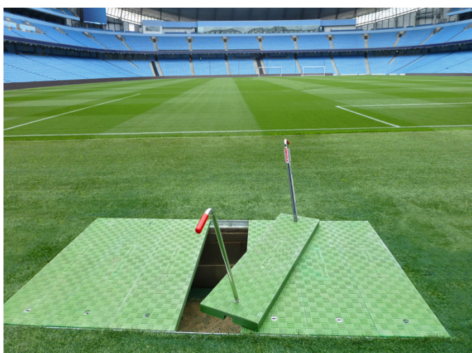
Grande vão: As tampas de vala da Fibrelite vão até 1600 mm de comprimento com capacidade uma de carga D400 (40 toneladas)
